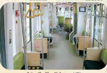
出入り口が広く、段差のない車内。車いすやベビーカーでも移動しやすいよ。
