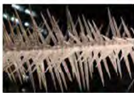
▲回転式巨大氷柱造形装置。放射状のつららができるよ
